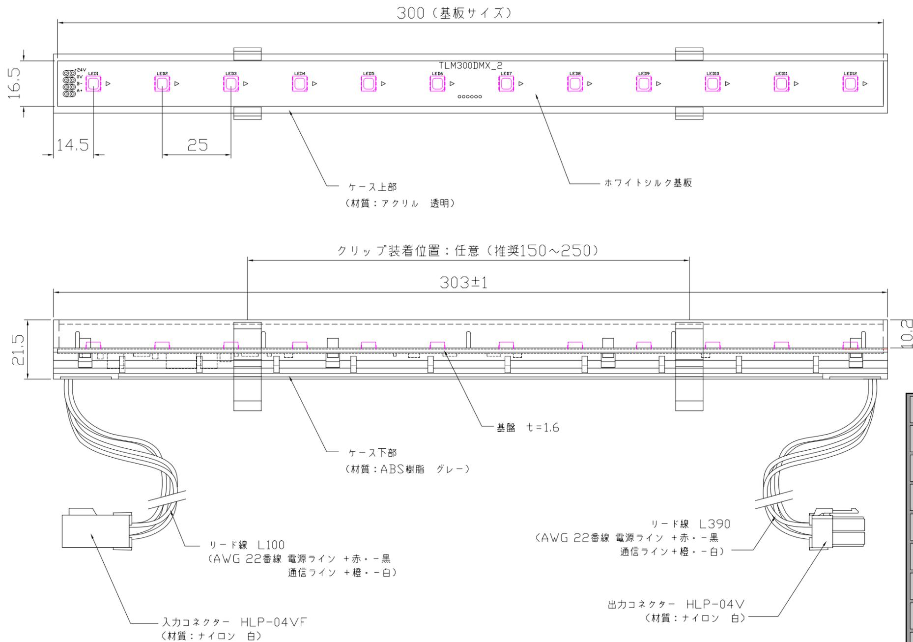
ケース側面の溝で角度を5段階に調整出来ます。
